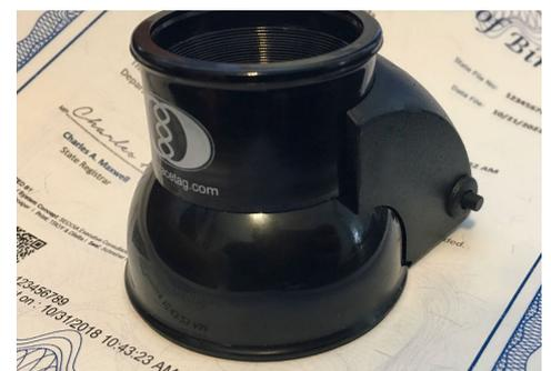
Modèle de vérificateur visuel compact pour la détection des traceurs luminescents ValiMark®.
